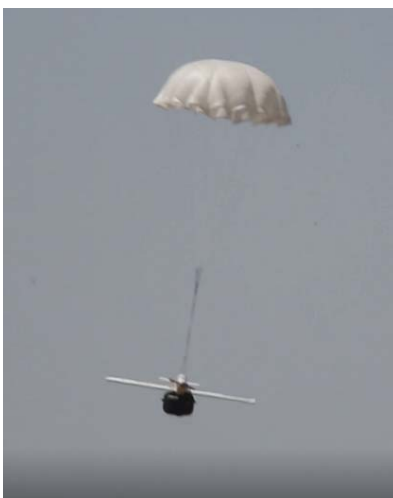
Рис. 5. Амортизационная подушка во время посадки БПЛА.
