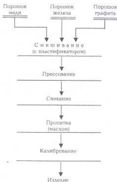
Фиг. 1. Технологическая схема получения железобитуминозных изделий [1]
