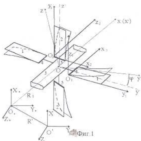
центральным телом 3 посредством жестких стержневых конструкций 4,5. Пластины однородные с толщиной  $h$  и размерами  $a, b$ . Они
