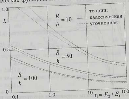
Фиг. 3 Зависимость длины зоны краевого эффекта от относительной толщины оболочки и ортотропии
