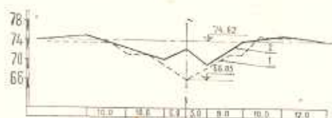
Фиг. 4. Результат маршейдерской съемки поперечного сечения выемки на участке коллектора ЦК-4-1 (ПК 12 + 10); 1 — проектный контур, 2 — фактический профиль.
