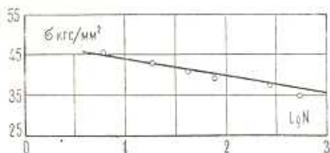
Фиг. 1. СВАН 1:1 на эпокси-фенольном связующем, растяжение вдоль волокон, \sigma_{вр} = 49.85 кгс/мм 2 , частота 3 цикл/мин. — расчет, ○ — эксперимент.
