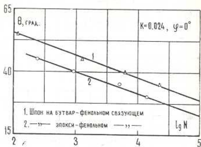
Фиг. 4. Влияние типа связующего (частота перегиба — 95 цикл/мин).
