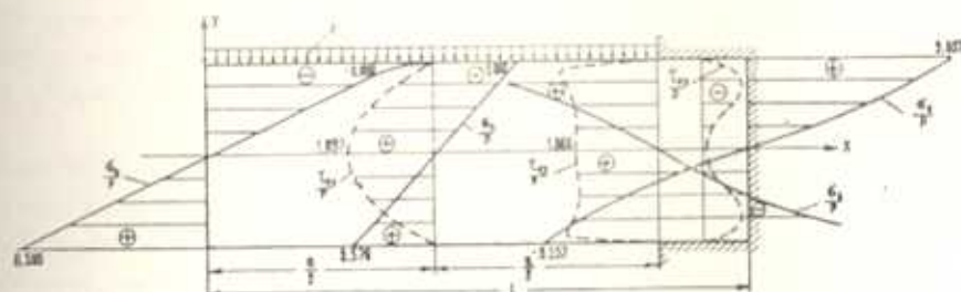
Фиг. 6. Эпюры \sigma_x и \tau_{xy} для случая h/a = 1/5 , h/l = 1/6
